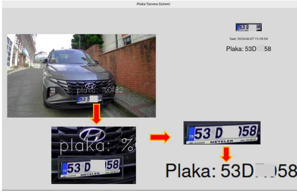
Şekil 9. Geliştirilen ara yüzün kameradan alınan anlık görüntüden sırasıyla plaka yakalaması ve görselleştirilmesi. (Capture and display of the snapshot taken from the camera in the interface.)
