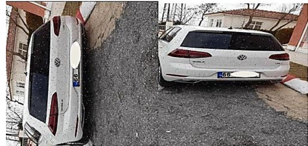
Şekil 8. Veri setinde bulunan görüntüden (sol) veri artırma ve 90° çevirme teknikleri kullanarak oluşturulan örnek görüntü (sağ). (The image of the image contained in the dataset (left) and improved image (right) using data augmentation and transferring techniques.)
