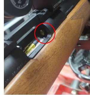
Şekil 14. Boş kovan çıkarmama hatası
