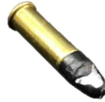
Şekil 15. Mermi sürememe hatası sonucu mühimmat
