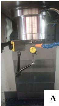
Şekil 1. Statik Ölçümler: A- Konik içi salgı ölçümü B- 300 mm test bar salgı ölçümü C- Takım çekme kuvveti ölçümü, Dinamik Ölçümler: D- Spindle eksenleri balans ve rulman sağlığı ölçümü
