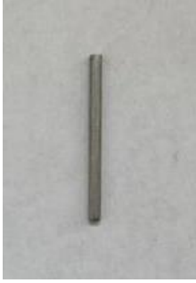
Şekil 1: Lazer tornalama operasyonu öncesi AISI 308L östenitik paslanmaz çelik çubuk.
