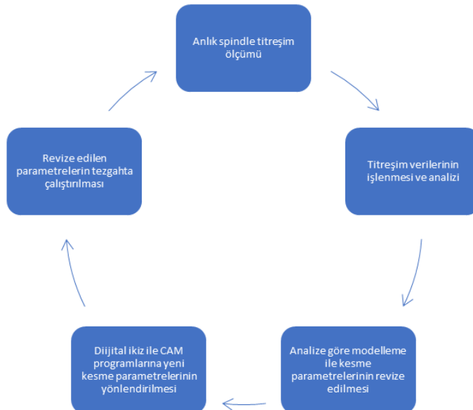
Şekil 3. Anlık veri toplaması ve dijital ikiz ile sürekli kontrol edilene ve izlenen sistem döngüsü
