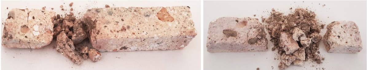
Şekil 5. Taş bünyelerin dağılması, Böltaş, R1 1040°C Sırlı krem renkli taş bünye (sol) ve R2 1040°C vişne renkli taş bünye (sağ)
