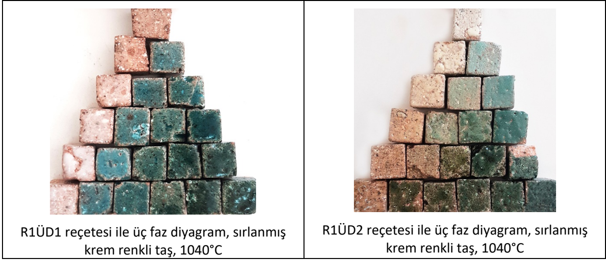
Şekil 11. Öz Kapadokya volkanik taş bünye üzerine uygulanan üçgen faz diyagram sır denemeleri
