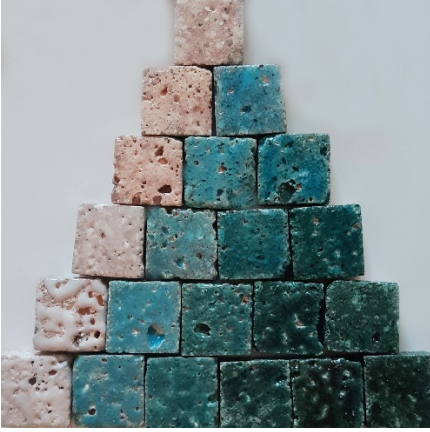
R1ÜD1 reçetesi ile üç faz diyagram, sırlanmış vişne renkli taş, 1040°C
