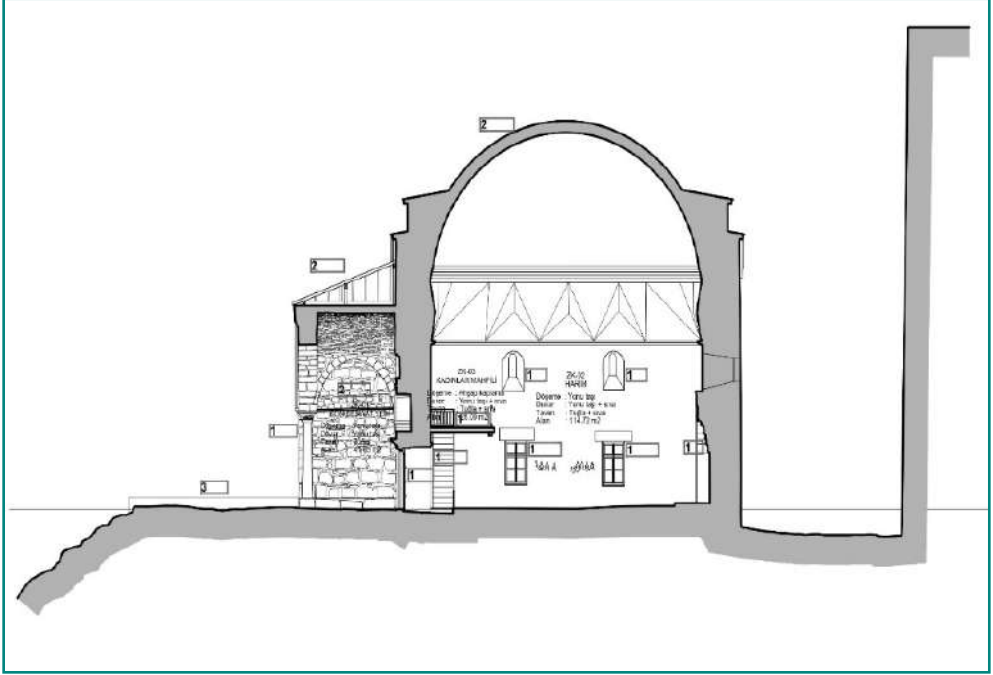
Şekil 11: I. Dönem restitüsyon kesit; Son cemaat yeri, harim ve güney yöndeki kule ilişkisi (Kuleli, 2013).
