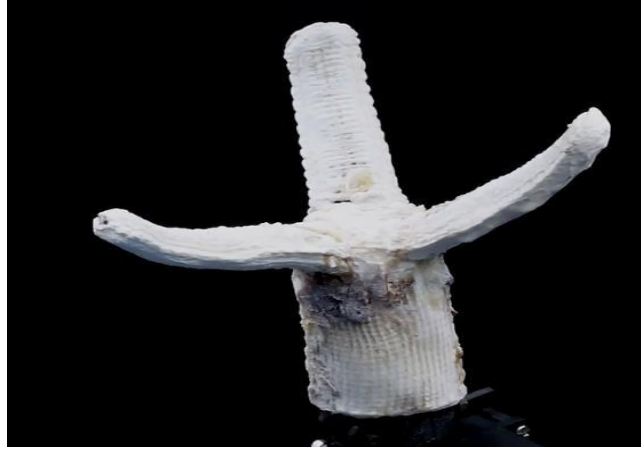
Şekil 11. Miselyum ile Üretilen Robotik Kol Ucu (Geleceğin Malzemeleri, 2024)
