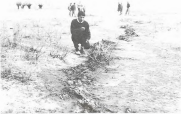
Şekil 6 Fırat vadisinde gözlenen kum, silt ve çamurla doldurulmuş çatı şekilli sırtlardan oluşan en echelon kırıklar (çekim batıdan doğuya).
