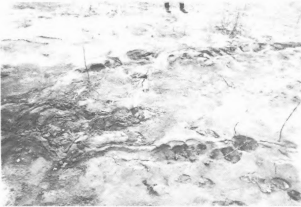
Şekil 8 Fırat vadisinde birbirine paralel iki en eşelon (sağ yanal) kırığı birleştiren köprü üzerinde kompresyon izlenirken kırıklar ve açılmalar gelişmiş. Ayrıca kırıklardan zemin sıvılaşması sonucu kum, silt ve çamur volkanları çıkmıştır (çekim güneyden kuzeye).
