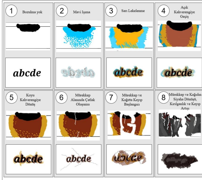
Şekil 3: Mürekkep korozyonunun bozunma evreleri, mürekkepte meydana gelen değişimler (üst) (Reißland & Hofenk, 2001), yazı alanında görülen görsel etkiler (alt) (Betül Küçük & Emre Yaman).
