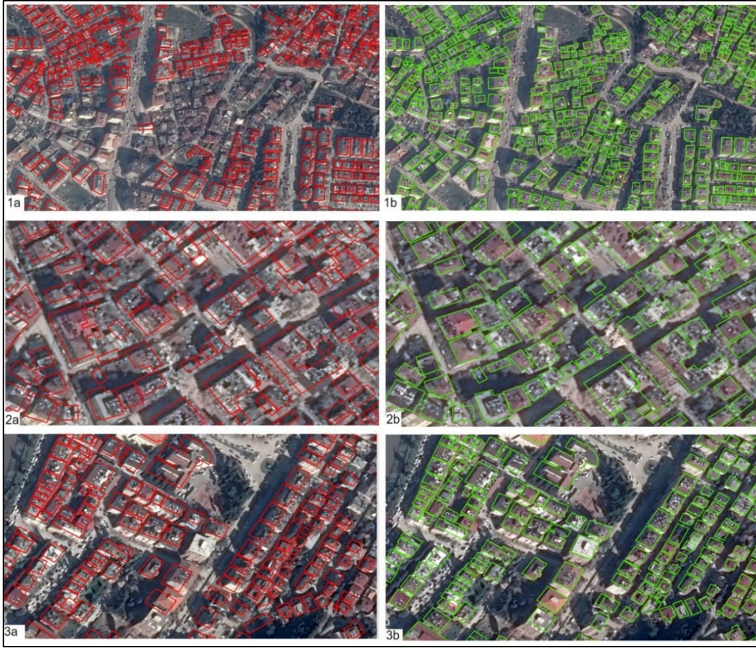
Şekil 4. OpenStreetMap aracılığıyla elde edilen bina ayak izleri ve hatalı olan verilerin düzenlenmesi. (Building footprints obtained through OpenStreetMap and correction of erroneous data)
