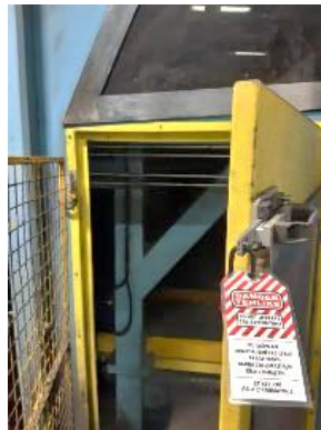
Şekil 5. Maça Pres Makinesinde Maça Sandığı Nozul Temizleme Operasyonu Sırasında EKED Uygulaması (LOTOTO Application During the Core Chest Nozzle Cleaning Operation in the Core Press Machine)
