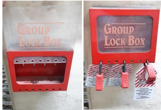
Şekil 3. Endüksiyon Ocağında Refrakter Bozma/Yapma Çalışması Sırasında EKED Uygulaması (LOTOTO Application During Refractory Degrading/Making Study in Induction Furnace)
