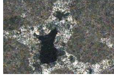
Şekil 6. Kireçtaşı örneğinde erime boşluklu doku. Boşluklar tümü ile doldurulmamış olup kaya az oranda gözeneklilik içerir (Büyütme: 10x).
