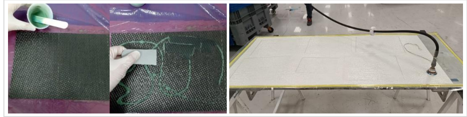
Şekil A: Karbon fiber takviyeli kompozitlerin üretim yöntemi / Figure A: Production method of carbon fiber reinforced composites
