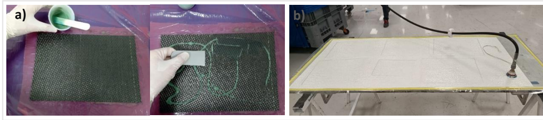
Şekil 2. a) El yatırma yöntemi ile kompozit üretimi b) vakum torbalama (a)Composite production by hand lay-up method b) vacuum bagging)
