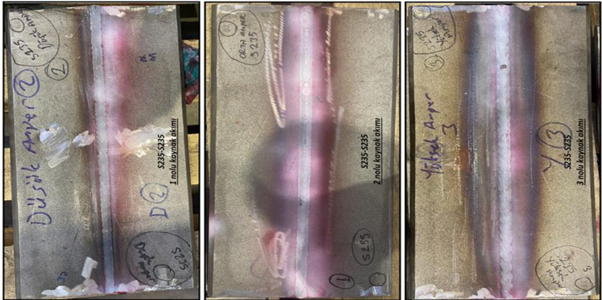
Şekil 3. S235-S235 1, 2 ve 3 numaralı parametreler kullanılan numunenin PT görüntüsü (S235-S235 PT image of the sample using parameters number 1, 2 and 3).
