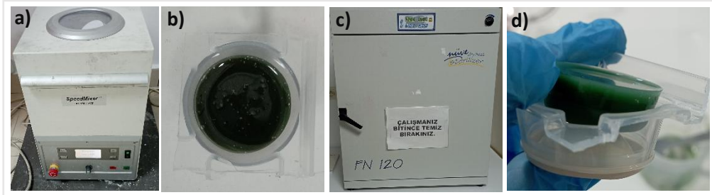
Şekil 1. a) Speed mixer b) kalıba alınan karışım c) kürlenme için etüv d) kalıptan çıkarılan numune (a)Speed mixer b) sample taken into mold c) oven for curing d) sample removed from mold)
