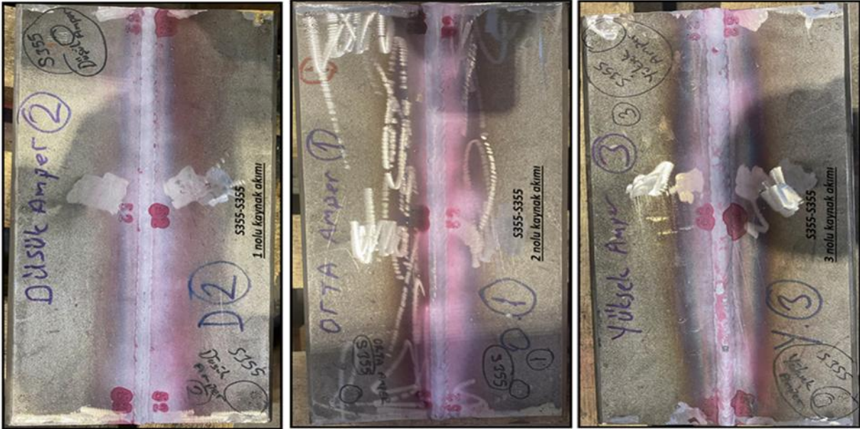
Şekil 5. S355-S355 1, 2 ve 3 numaralı parametreler kullanılan numunenin PT görüntüsü (S355-S355 PT image of the sample using parameters number 1, 2 and 3).
