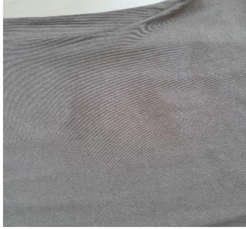
Şekil 10. Ütüleme işleminden kaynaklanan kararma Figure 10. Darkening caused by ironing
