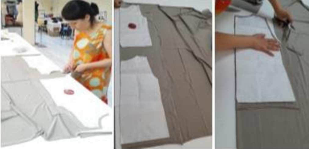
Şekil 8. Kumaşın kesim aşamasından görseller Figure 8. Images from the fabric cutting phase
