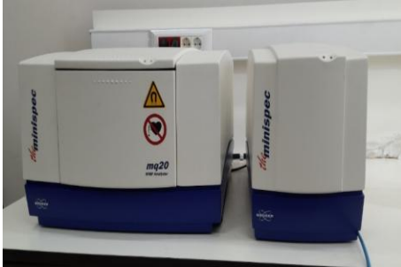
Şekil 2.1 Bruker Minispec TD- NMR Cihazı (20MHz-0.5T)
