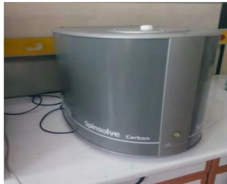
Şekil 2.2 Magritek Spinsolve NMR Cihazı (42MHz-1T)
