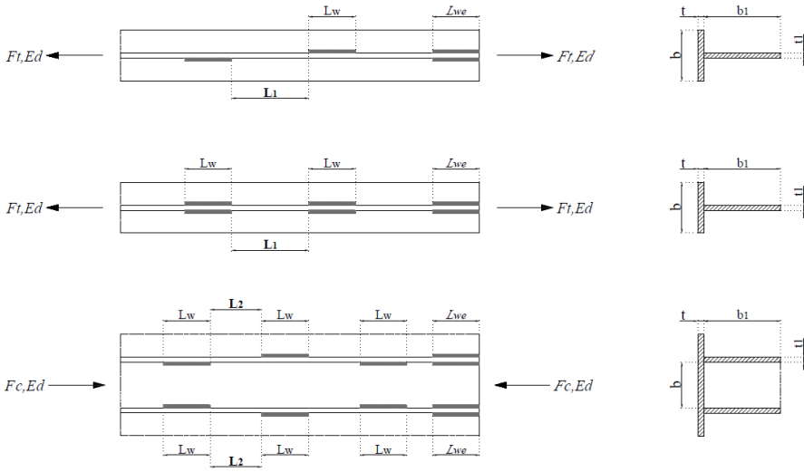
Şekil 14. Aralıklı Metot Köşe Kaynak Boşlukları ( L_1 , L_2 ), Dizimleri Ve Eksantrik Yerleşim Planı (Atak ve Şık, 2015)
