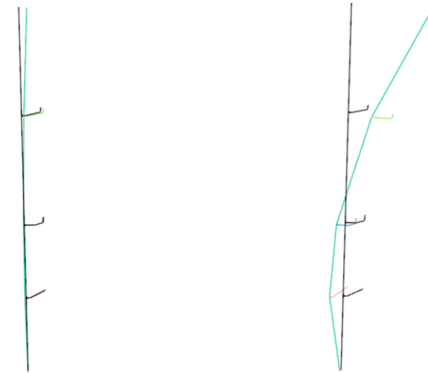
Şekil 11. SYSWELD Kaynaklı İmalat Simülasyon Ortamında Kaynak Sonrası Kirişin Çarpılma Davranışı Ve Yönelimleri (Nominal Durum, Soldaki Görsel ve 10 Kat Abartılı Durum, Sağdaki Görsel)
