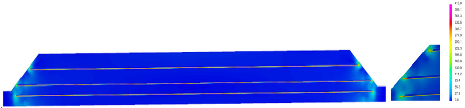
Şekil 9. Visual Assembly Simülasyonu Kalıntı Gerilmeleri Sonuçları ( \sigma_{max} = 416.8 MPa)
