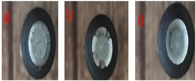
Şekil 4. Numunelerin kırık kesitlerinin makro görüntüsü: a) S, b) SK, c) SKT
