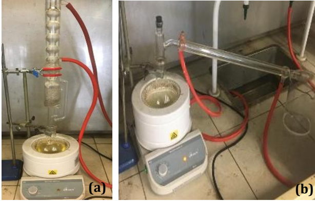
Şekil 2. a) Soxhlet Ekstraksiyonu Yöntemiyle Bitkisel Yağ Elde Edilen Deneysel Düzenek b) Damıtma Sistemi Düzenegi
