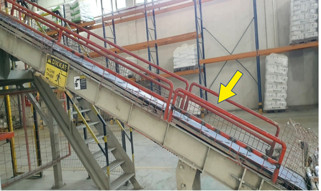
Görsel 4. Izgara Ve Korkulukların Eklenmesi
