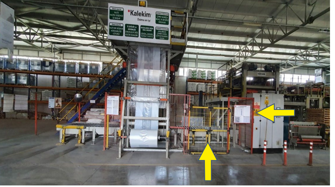
Görsel 1. Paketleme ve Paletleme Makinelerinin Etrafının Kapatılması
