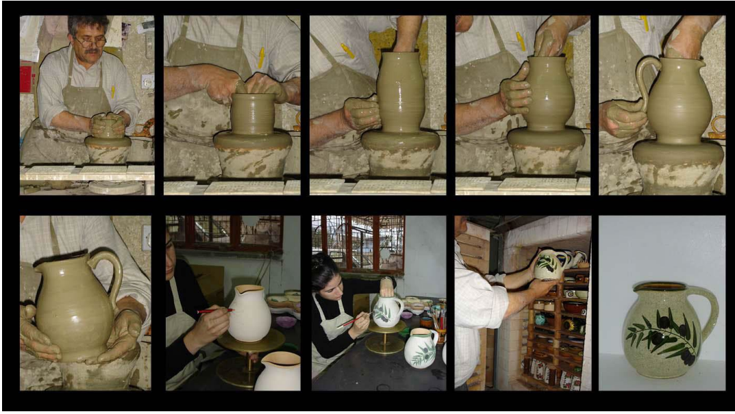
Görsel 6. Dizayn 74 Seramik Atölyesinde Tipik Bir Sürahinin Üretim Aşamaları, Hasan Eminağa Arşivi.
