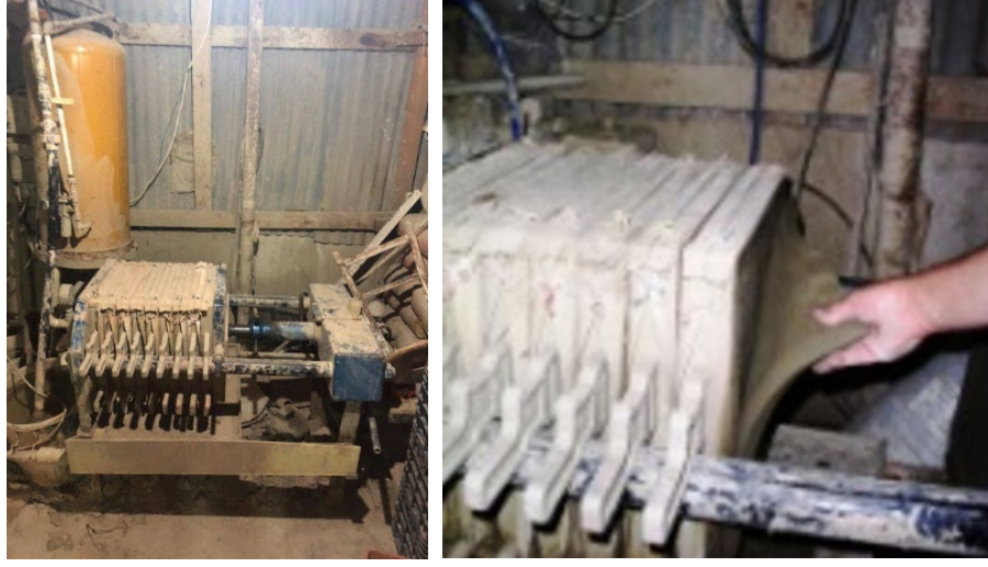
Görsel 4. (Solda) Filtrepres, 2019. Kişisel Arşiv. (Sağda) Filtrepreden Çıkan Kil, 2019. Kişisel Arşiv.
