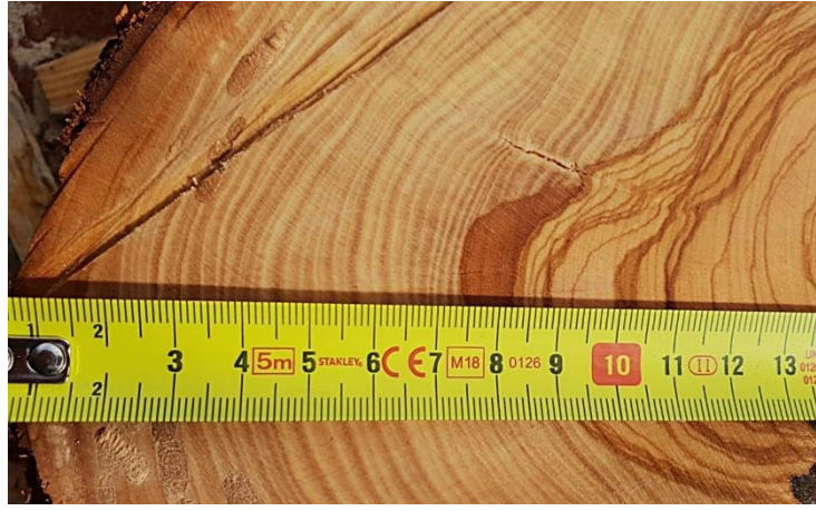
Fotoğraf 5- Kesilmiş zeytin ağaçlarının yüzeyi zımpara ile temizlendikten sonrası ile ıslatılarak büyüme halkalarının daha belirgin hale gelmesi sağlanmıştır.
