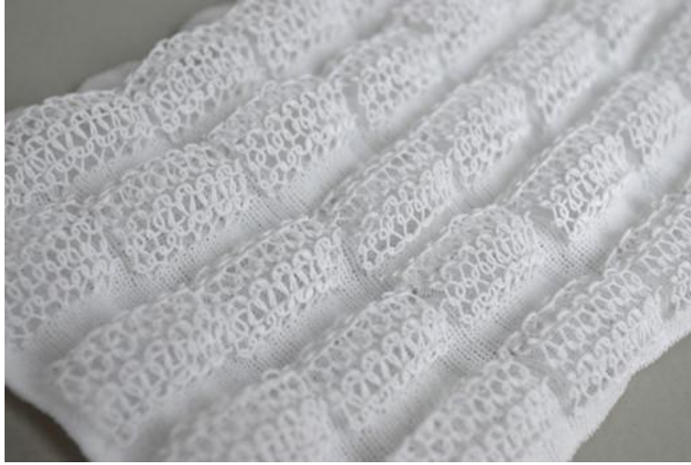
Görsel 5. 3B Baskı ile Tekstil Yüzey Örneği
