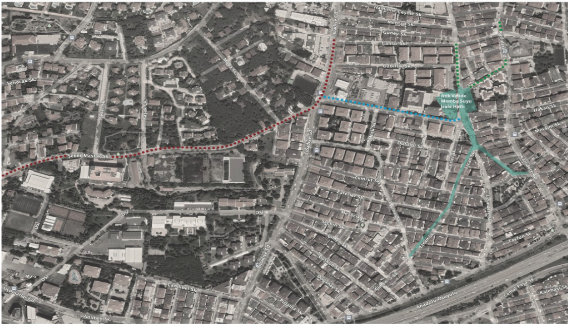
Şekil 18. Çinili suyunun Atik Vâlide suyunun "Toygar kolu" olarak bağlanması ve Şeker Maslak Sokak üzerinden batı istikametinde yoluna devam etmesi.
