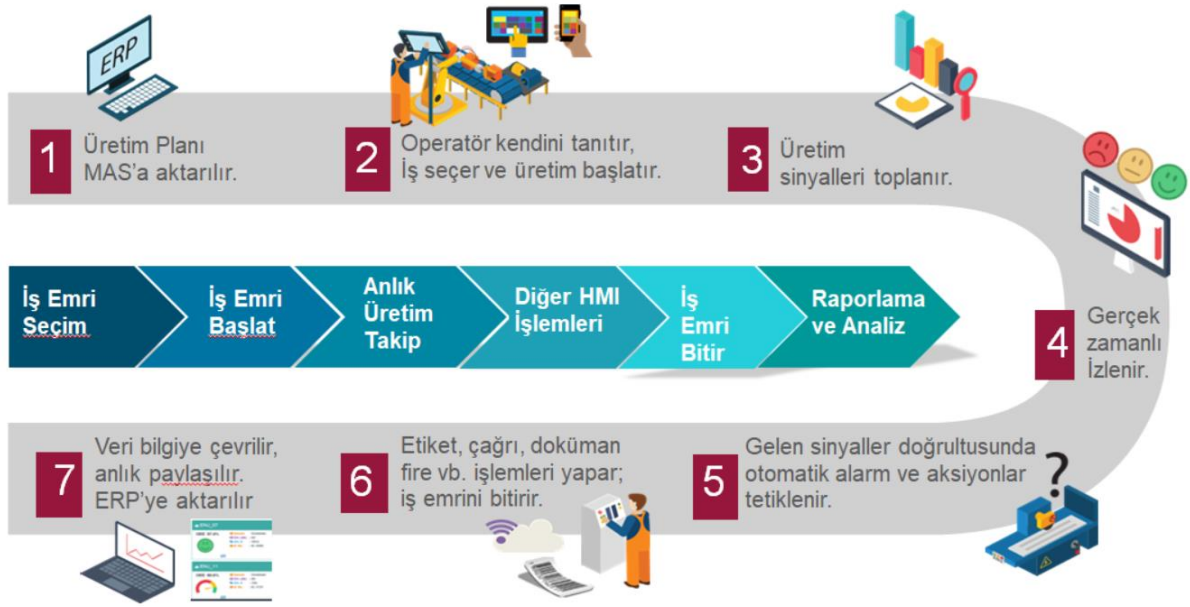
Şekil 3: Tasarlanan MES Sistemi Akışı
