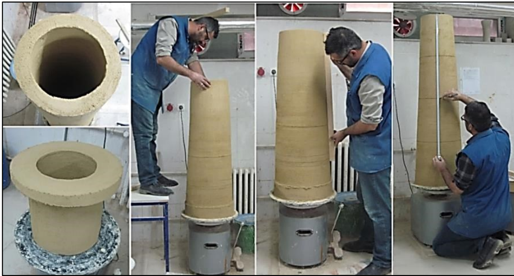
Şekil 10. Ana gövdenin istenilen yüksekliğe getirilmesi ve kesim yerlerinin belirlenmesi.
