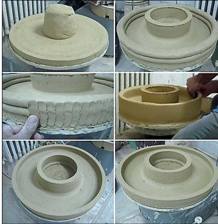
Şekil 12. Alt havuz kısmının tornada oluşturulması.
