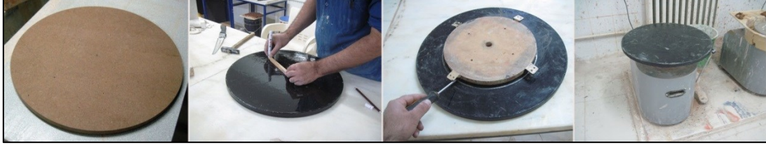
Şekil 5. Taban plakasının hazırlanması ve turnet üzerine yerleştirilmesi.
