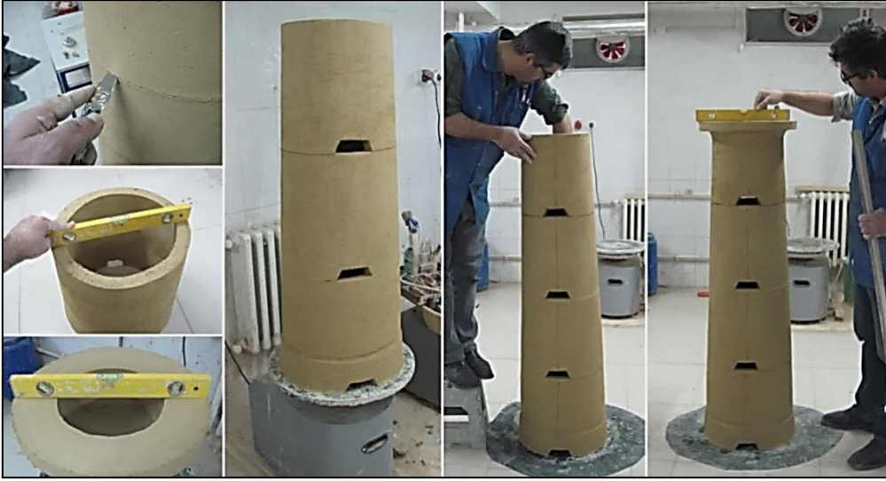
Şekil 11. Şekillendirilmesi tamamlanmış 4 bloktan oluşan ana gövde.
