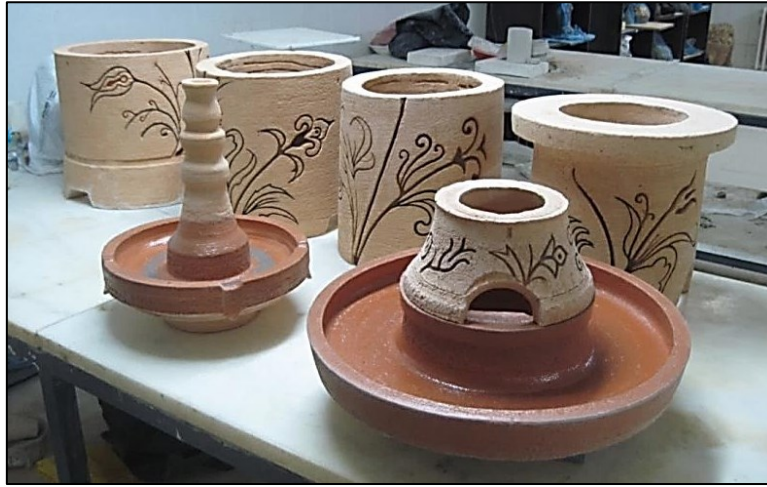
Şekil 17. Ana yapıyı oluşturan, dekorlaması tamamlanmış ve pişirme işlemi gerçekleştirilmiş 6 adet parçanın montaj öncesi görünümü.
