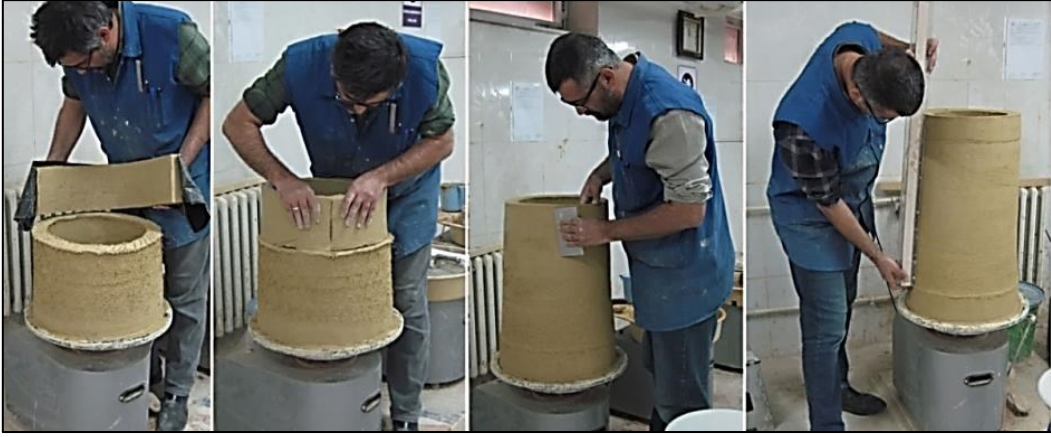
Şekil 9. Oluşturulan kısmın dış düzeltmelerinin yapılması ve gönyeye alınması.
