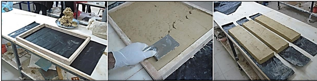
Şekil 6. Gövdeyi oluşturacak 4 cm kalınlığındaki plakaların hazırlanması.
