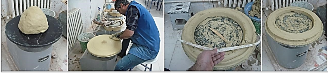
Şekil 7. Taban şablonunun tornada çekilmesi.
