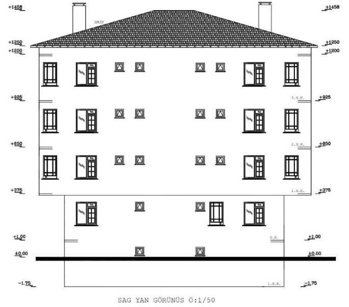
Şekil 4. Binanın sağ cephesi.
