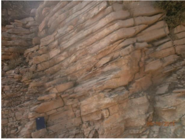
Şekil 4. Dumanlı formasyonuna ait süreksizlikler
