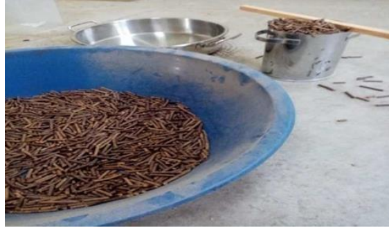
Şekil 11. Erik ve kıvılcık meyvesinin çekirdeklerinin karışımından elde edilen peletler
