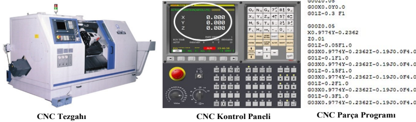
Şekil 10. CNC torna tezgahı, CNC kontrol paneli ve dijital kodlardan oluşan parça programı
