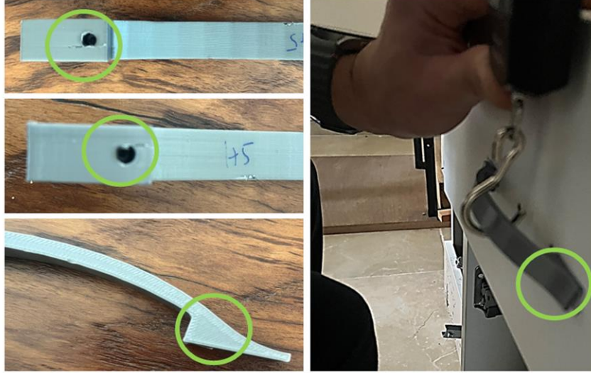
Şekil 4. Test sonunda PETG gri renk malzeme ile üretilen numunelerin deformasyonuna dair görüntüler
