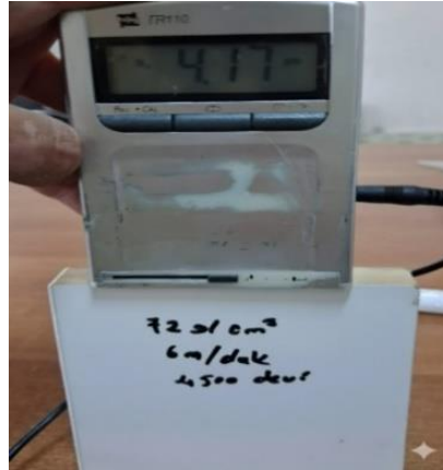
Şekil 3. Pürüzlülük ölçüm işlemi.
