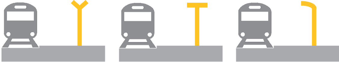
Şekil 3. Donatılı Gazbeton Gürültü Bariyerleri ile kırınımlı sesin etkisini azaltmaya yönelik tasarımlar
