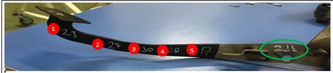
Şekil 1.7. Boya kalınlık ölçümleri-2
