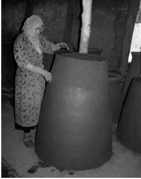
Şekil 12. Tandır Yapımında Bantların Düzlenmiş Görünüşü
