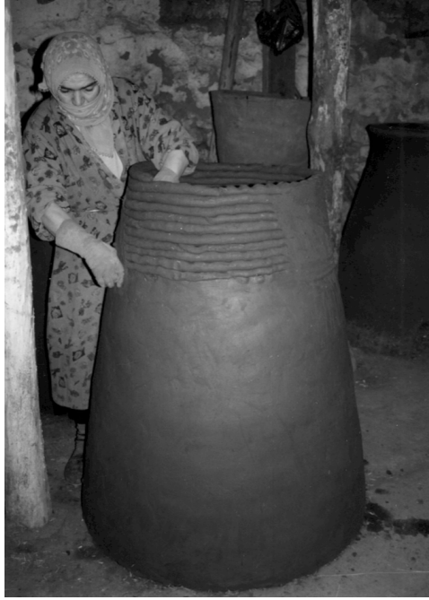
Şekil 11. Tandır Yapımında Bantların İçten ve Dıştan Elle Düzeltilmesi
