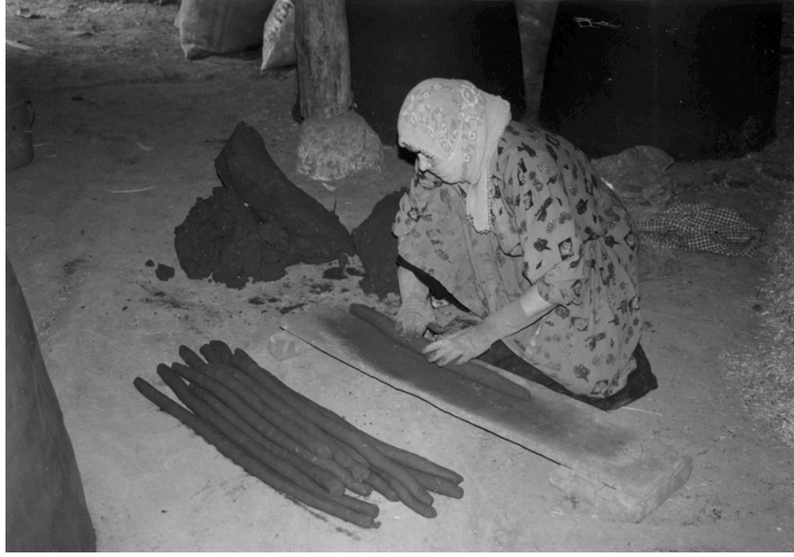
Şekil 8. Tandırın Yapımında Bantların (Loloz) Hazırlanması
