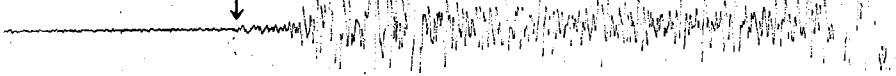
Şekil 6. 2-8 Hz. band-geçişli filtre kullanmak suretiyle ISK istasyonuna ait bir kaydın sismik gürültülerden arındırılması
