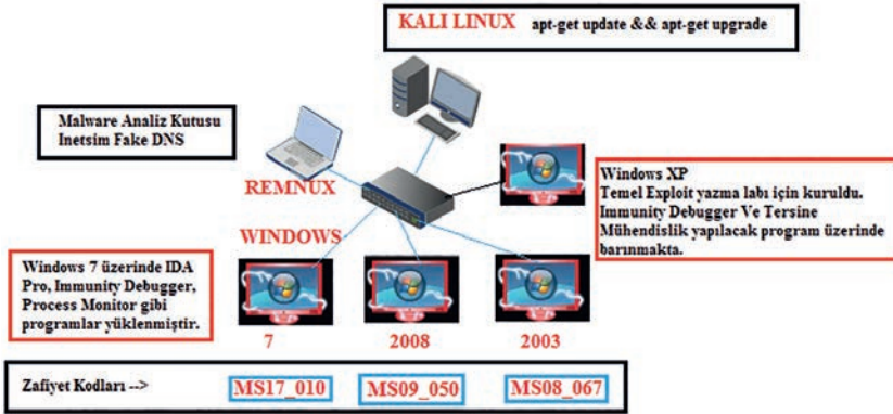
Şekil 9.2. Test kapsamında oluşturulan yapının blok şeması
